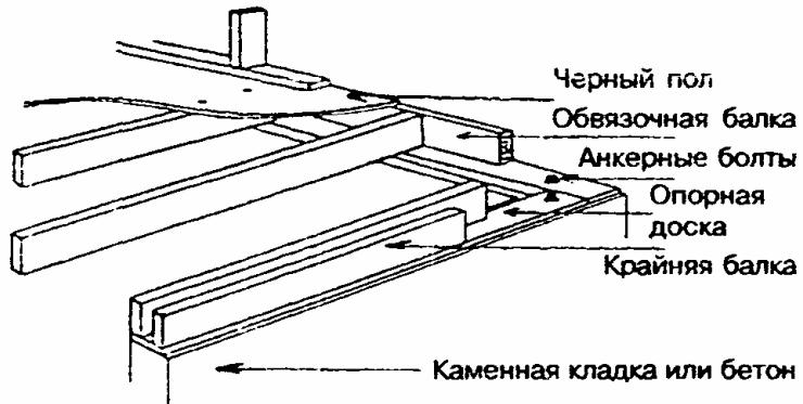
*Рисунок 6.4 - Опирание прогонов (балок) перекрытия на опорную доску, уложенную на фундаментную стену*
