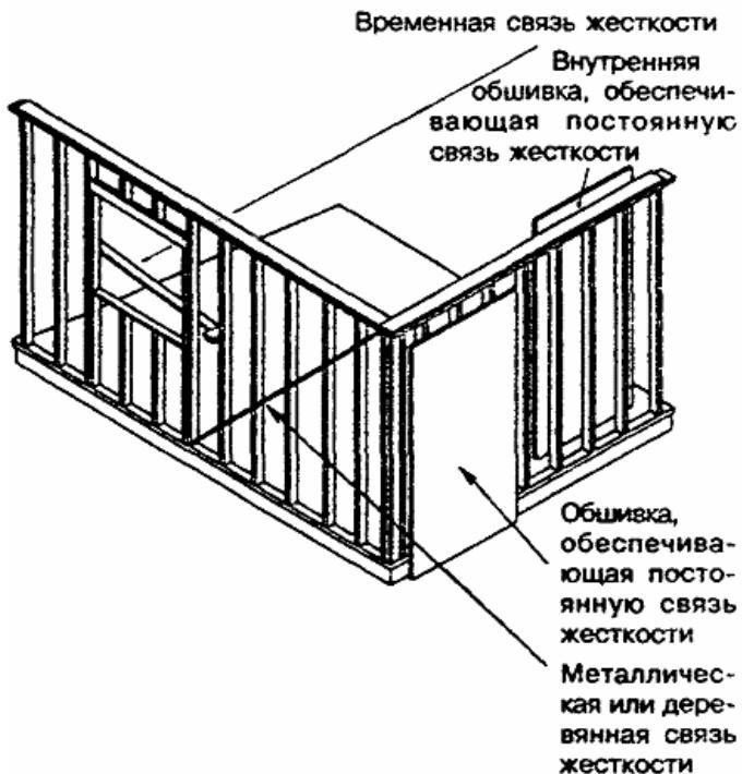
*Рисунок 7.1 - Каркас стены*
