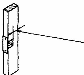
В стойках каркаса несущих стен размер отверстия для прохода труб не должен превышать 2/3 ширины стойки, в противном случае стойки должны быть соответственно усилены
