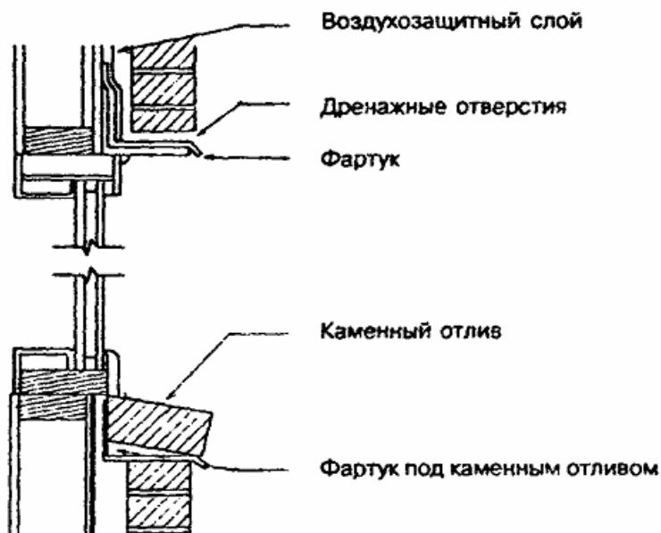
**Рисунок 10.2 - Установка фартука под каменным отливом**
