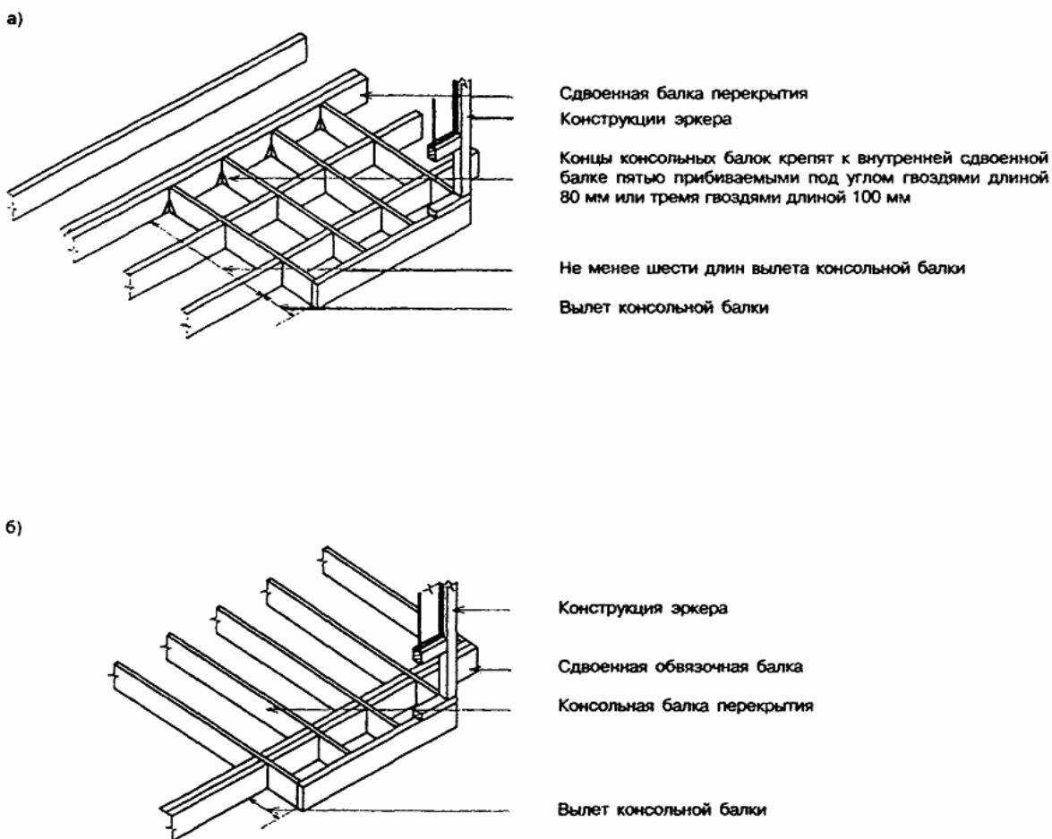
а - консольные балки расположены перпендикулярно балкам перекрытия; б - консоли являются продолжением балок перекрытия
