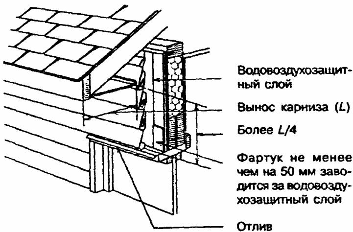
**Рисунок 10.4 - Фартук над оконным (дверным) проемом**
