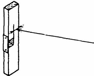
В стойках каркаса перегородок размер отверстия для прохода труб должен быть меньше ширины стойки минимум на 40 мм, в противном случае стойки должны быть соответственно усилены
