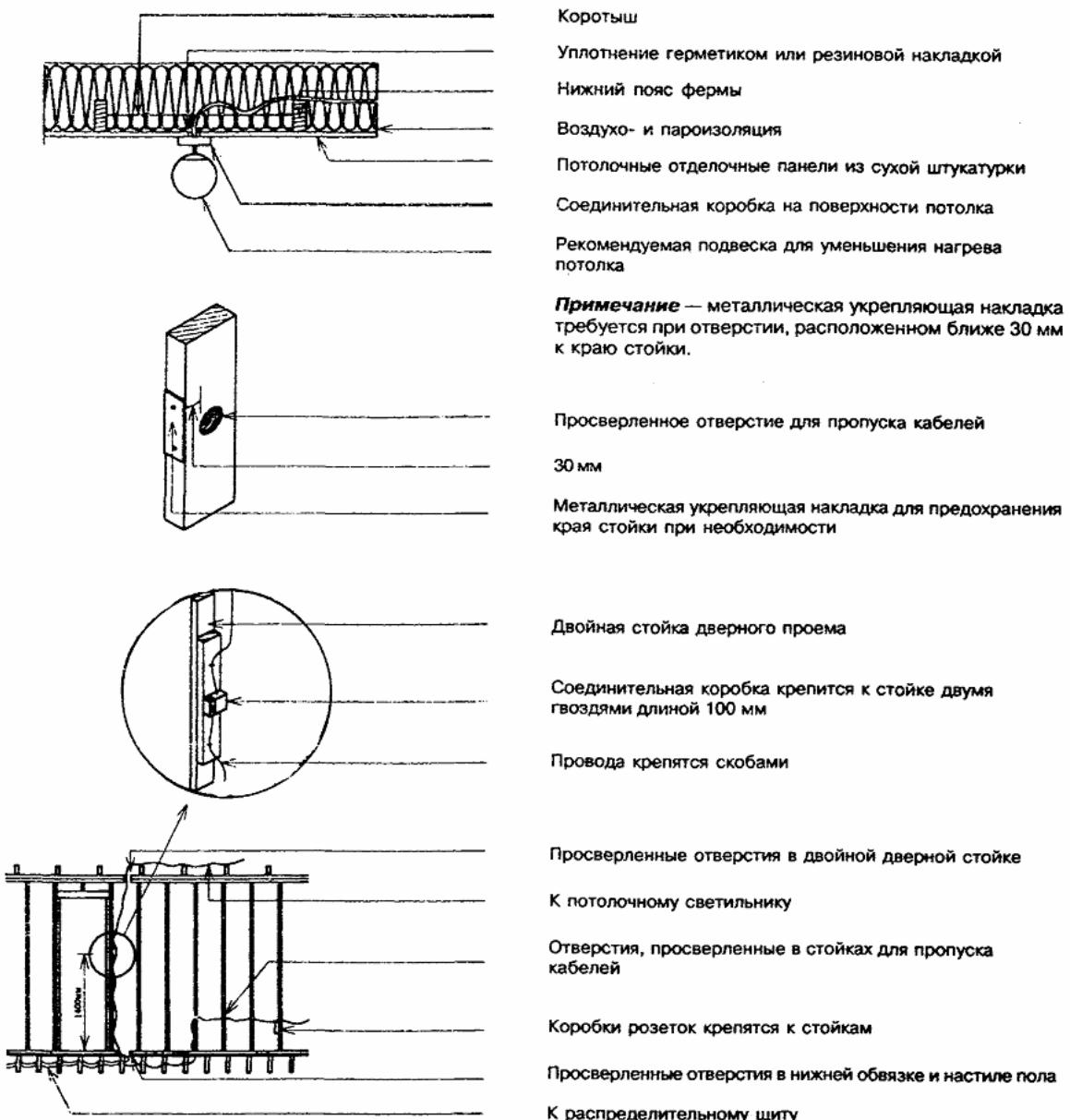
**Рисунок 13.9** - Прокладка электрических проводок в элементах каркаса
