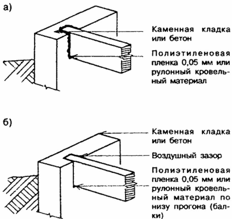
а - низ прогона (балки) расположен над уровнем грунта; б - низ прогона (балок) на уровне грунта или ниже
