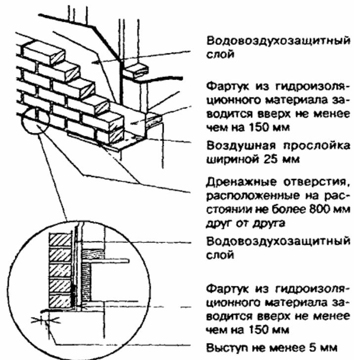
**Рисунок 10.3 - Фартук под дренажными отверстиями каменной облицовки**
