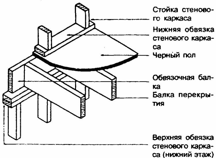
*Рисунок 6.6 - Опирание балок перекрытия на каркас наружной стены*
