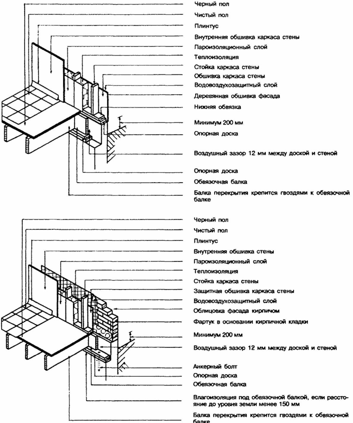
**Рисунок 6.5 - Опиление балок перекрытия на опорную доску, уложенную на уступ фундаментной стены**
